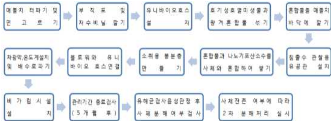
그림 1. 호기성호열미생물을 이용한 가축사체 처리 절차도
